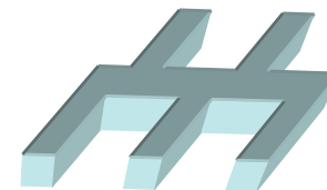
Bâtiment peu compact
